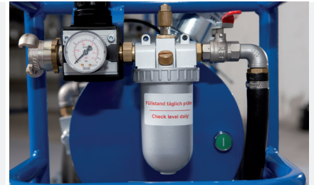
Druckminderer mit Manometer und Frostschutzeinrichtung
